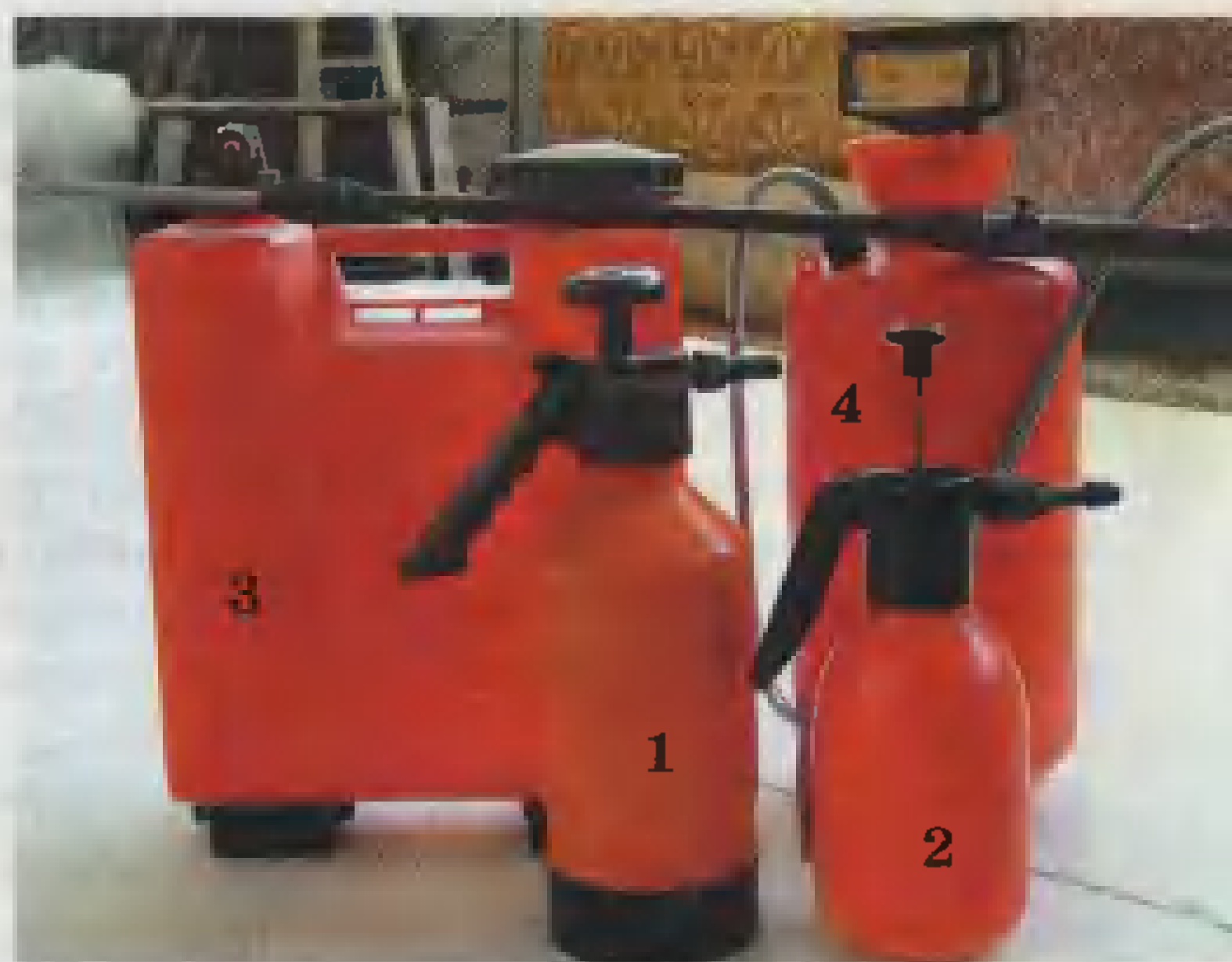
1 и 2 — ручные опрыскиватели; 3 и 4 — помповые. Самый большой заправляют, не снимая распылителя
